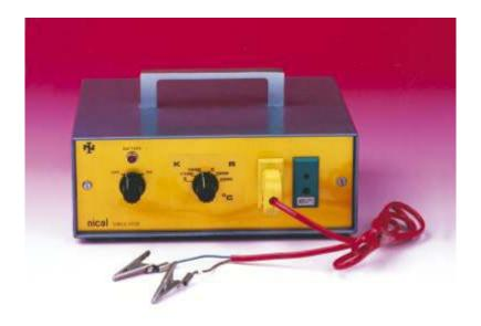
El simulador de temperatura Nical pone en evidencia y seguridad si un pirómetro registra correctamente la temperatura.
