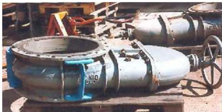
*Válvula reparada mediante la aplicación de Ultrametal Acero*
