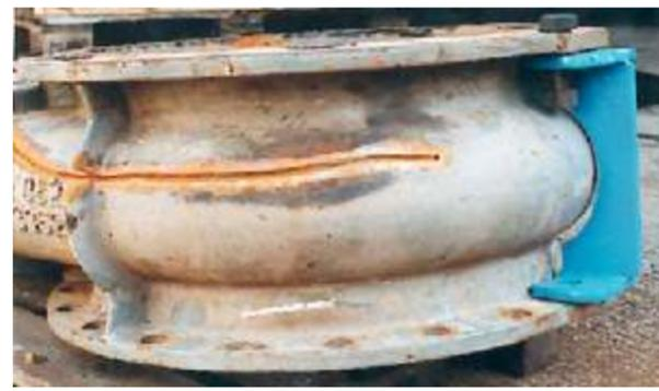
*Grieta longitudinal en forma de V de una gran válvula de acero*
