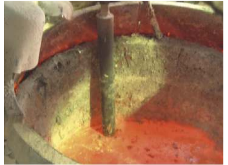
Instalación de una vaina de Carburo de Silicio dentro de un horno de crisol
