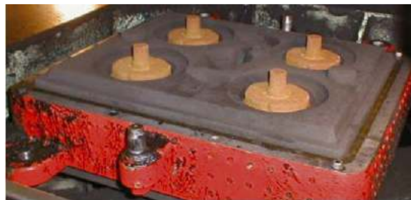
Molde procedente de una máquina horizontal Klunker conteniendo Green Sand Conditioner 2
