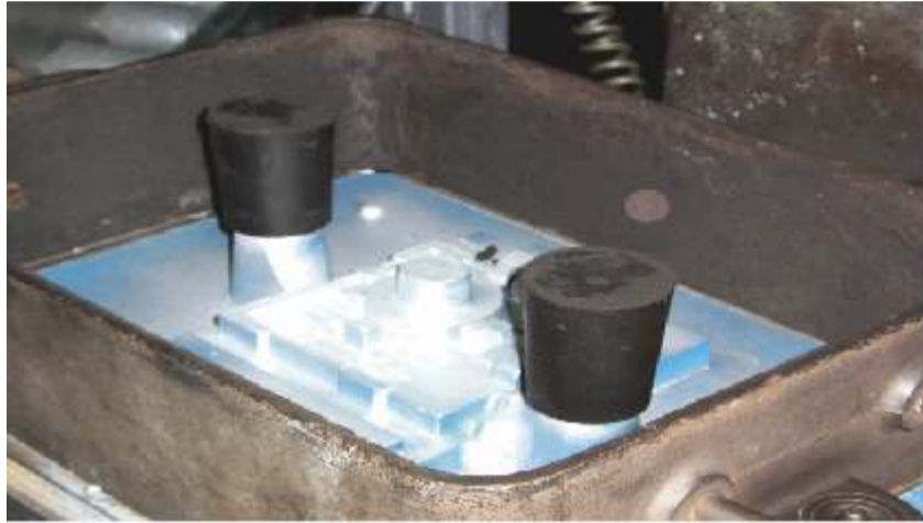
Posicionado de 2 mazarotas de goma redondas en el modelo antes de verter la arena de moldeo
