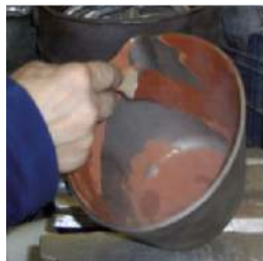
Pintado de un pote para 6 kgs. de aluminio
