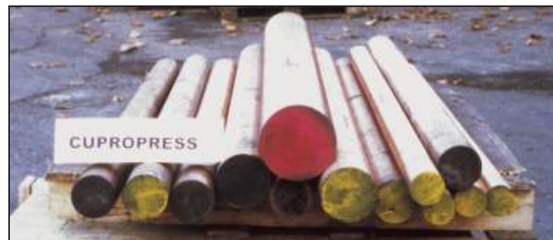
Barras de aleaciones de cobre para la construcción de pistones para máquinas de inyectar cámara fría.
