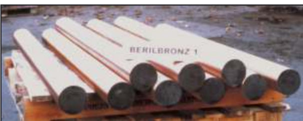
Barras de aleaciones de cobre para la construcción de pistones para máquinas de inyectar cámara fría.
