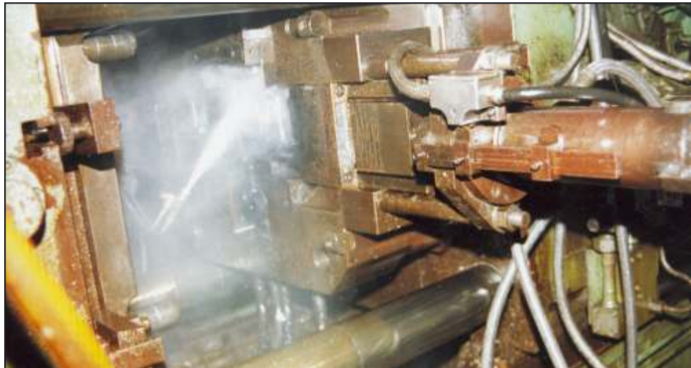
Aplicación del desmoldeante Process 900T-7
