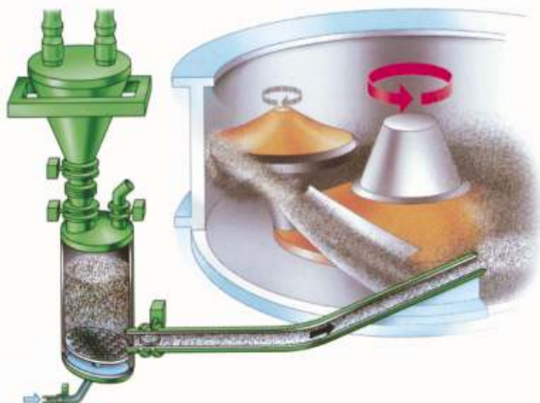
Esquema de la instalación de inyección de bentonita en el lecho de arena en el molino SPEEDMULLOR, donde se observa en su interior el sentido de giro entre rotores y aspas.
