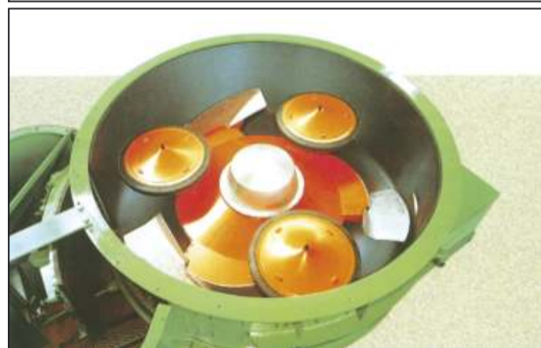
Vista interior del Molino SPEEDMULLOR donde se observa los tres discos o rotores y las aspas para lograr una rápida y eficiente mezcla. Un ciclo completo para 170 toneladas de arena dura 90 segundos.
