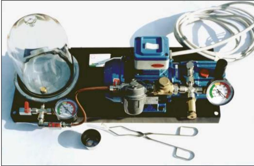
La presencia de un exceso de gas en el aluminio fundido acostumbra a causar problemas de poros en las piezas, con el inconveniente añadido que aparecen después de la labor del mecanizado, provocando pérdidas económicas y de prestigio.
