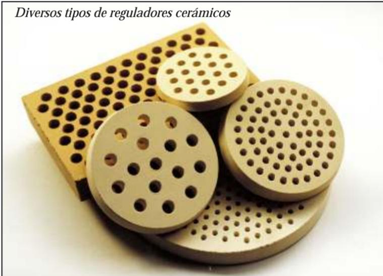
Los reguladores de caudal de metal en el molde, alojados en la unión de las dos medias cajas, logran que el metal llene de forma laminar y suave la cavidad del mismo, sin turbulencias ni salpicaduras, evitando así la erosión de la arena, aires atrapados y oxidaciones, que afectan desfavorablemente al metal y afean la pieza.
