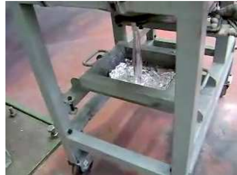
3. Con elevación de temperatura y agitación se recoge el aluminio
