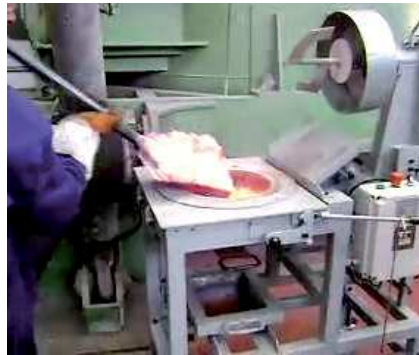
2. Escoria incandescente del horno a la Recuperadora
