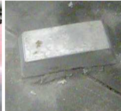
4. Lingote de aluminio procedente de las escorias (fotografía 1)
